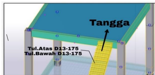
Gambar 8. Detail 3D Tangga #1 Pada Rektorat Universitas Internasional Batam
