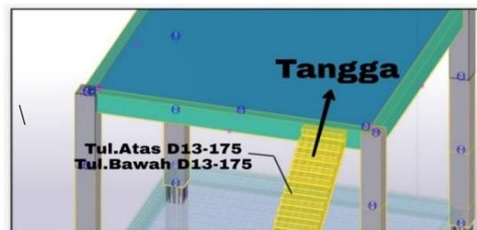
Gambar 8. Detail 3D Tangga #1 Pada Rektorat Universitas Internasional Batam
